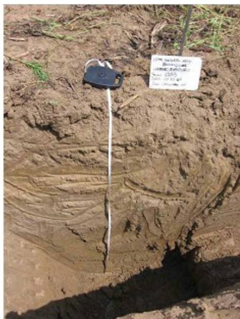
Fig. 1.4.2. Escavazione trincee e prelievo di incrementi lungo le pareti di scavo.
