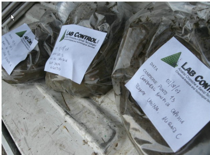
Fig. 1.5.1. formazione delle aliquote, opportunamente identificate e catalogate. Il numero di aliquote prelevate deve essere riferito nel MAC.
