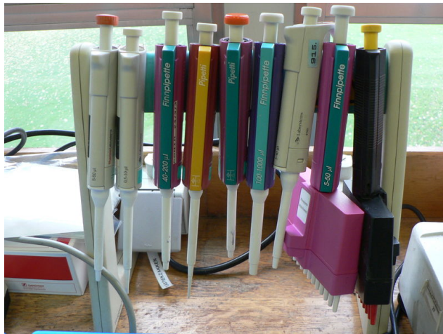
Fig. 3.2.1. esempi di micropipette (fonte Wikipedia)
