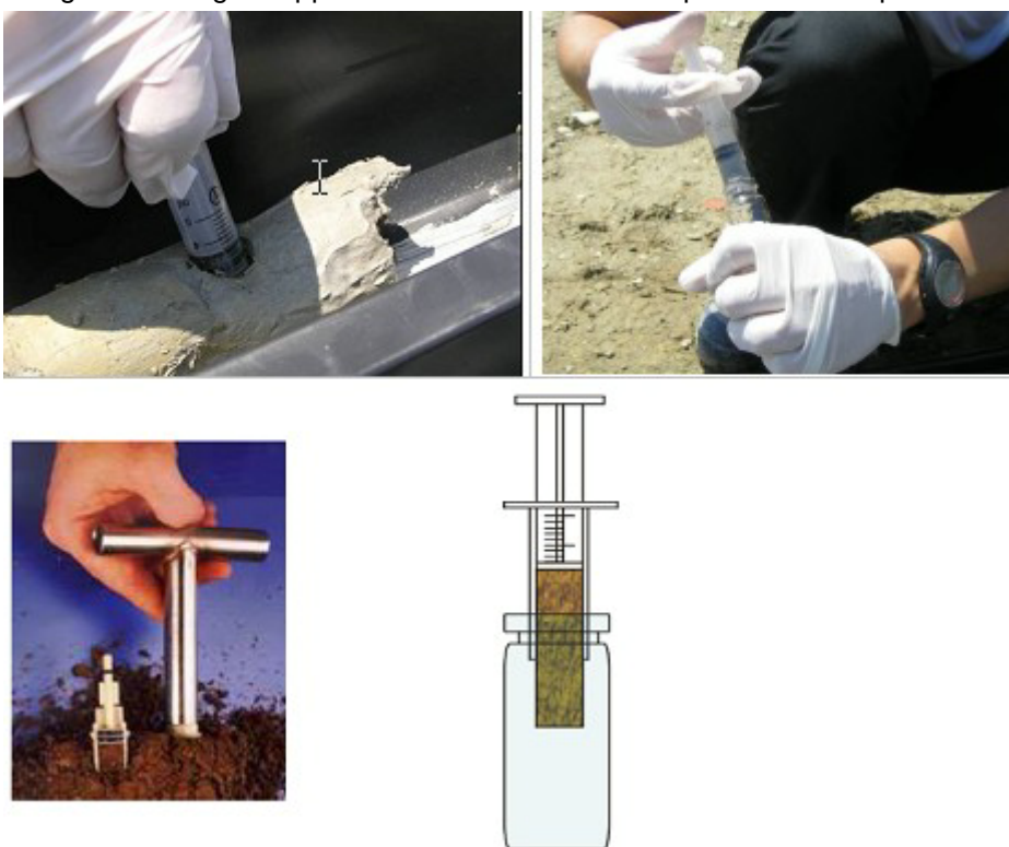
Fig. 1.4.5. formazione del campione in vial per l'analisi dei composti volatili
