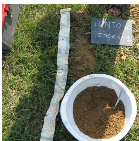
Fig. 1.4.4. trivellazione con dispositivi manuali e ricostruzione indicativa della colonna stratigrafica.
