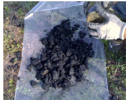
Fig 2.5.1. metodo di selezione degli incrementi per comporre ciascun campione medio composito. A destra risultato della quartatura e preparazione del campione
