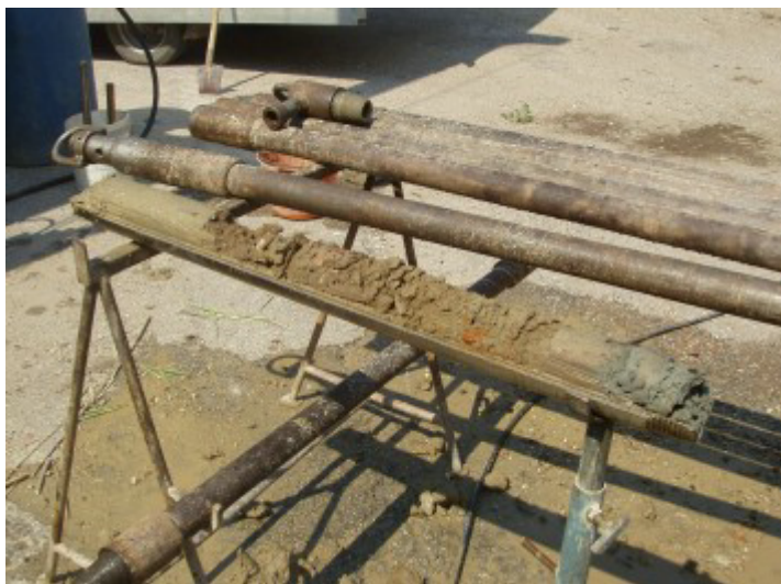
Fig. 1.4.1. estrusione delle carote prelevate con carotiere semplice
