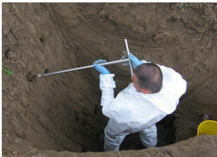
Fig. 1.4.2. Escavazione trincee e prelievo di incrementi lungo le pareti di scavo.
